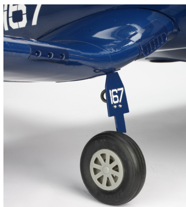
Pevný podvozek lze nahradit volitelně elektrickým zatahovacím podvozkem.
