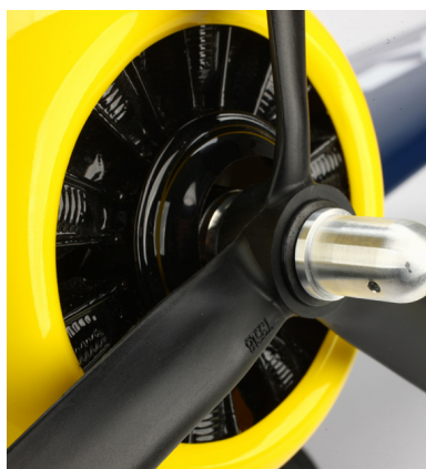
Laminátový kryt motoru s maketou hvězdicového motoru.
