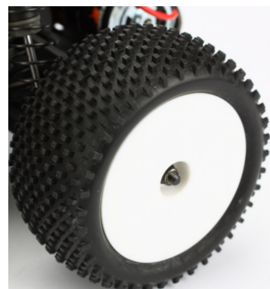
Zadní kola s kolíkovým dezénem pro maximální záběr, přední s drážkami pro přesné řízení.
