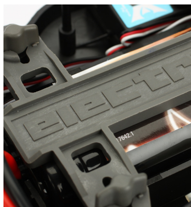
Baterie je umístěna v centrální části auta pomocí poutací pásky a držáku s rychloupínáním.
