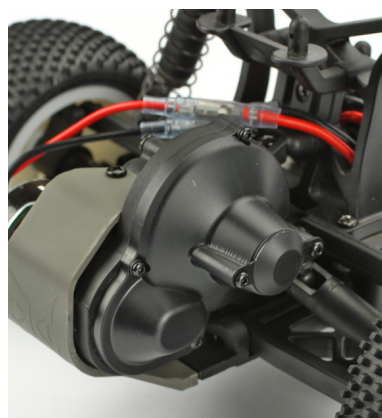
Převodovka s kluznou nastavitelnou spojkou
