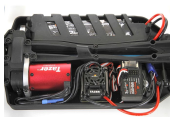
Nainstalovaný 4 pólový motor Dynamite® Tazer™ 3300Kv, přijímač SRS4200 se stabilizací AVC a střídavý regulátor Dynamite® Tazer™.
