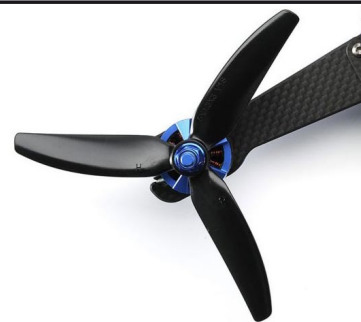
Blade Vortex 230 Mojo pohání čtveřice motorů 2206 2300Kv s 3-listými vrtulemi 5X4X3V1S.
