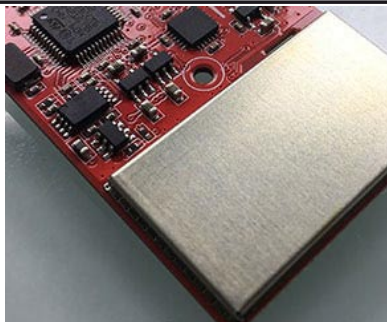
Dynamické ovládání výkonu, které používá Vortex 230 Mojo umožňuje dynamické nastavení od 1mW až po maximální výkon.
