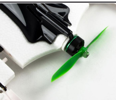
Model pohání střídavý motor Thrust™ 2205-2350Kv s 2-listou vrtulí 5x4.
